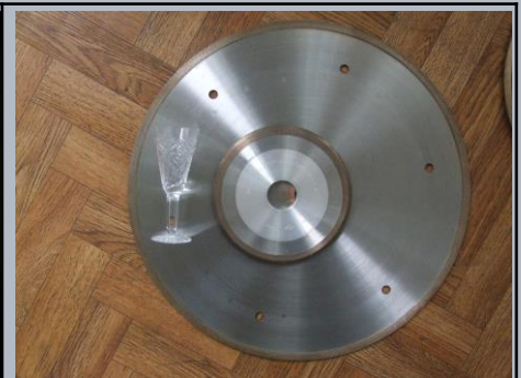
Outil pour le coupage de verre de forme 1A1R d'un diamètre 500 mm et la meule de forme 1EE1 150 mm pour la rectification de forme de verre
