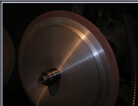
Meule de forme 14EE1 pour la rectification de forme de verre d'un diamètre de 200 mm
